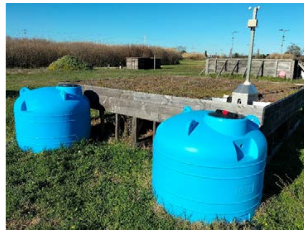
Figura 5. BGR pilota installato presso l'università della Tuscia, Viterbo. Da notare i due serbatoi da 1000 litri utilizzati per la misurazione del deflusso dal BGR.
