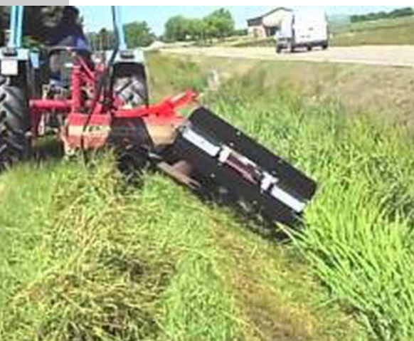
DIVERSE CONDIZIONI OPERATIVE TIPICHE DELLO SFALCIO EFFETTUATO DA TRATTORI (A SINISTRA) ED ESCAVATORI (A DESTRA).
